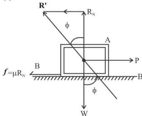
जहाँ,  $R'$  = परिणामी प्रतिक्रिया,  $R_N$  = अभिलंब प्रतिक्रिया,  $\phi$  = सीमान्त घर्षण कोण (Angle of limiting friction)
